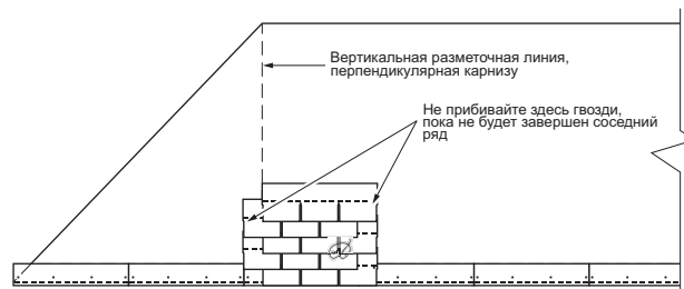
Рисунок 5. Метод вертикальной укладки.
