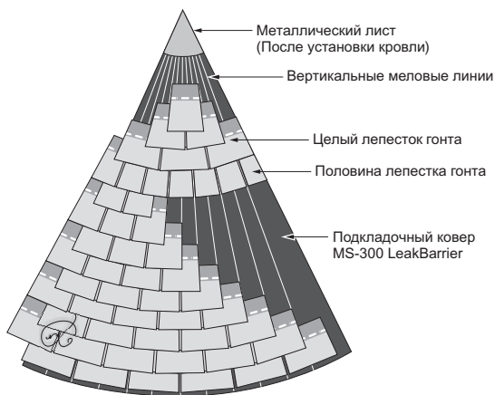
Рисунок 6. Установка кровли на конус.
